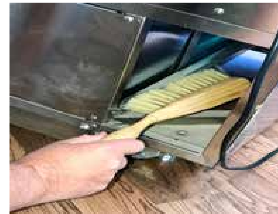
拆下背部小型格栅，即可以触及冷凝器
